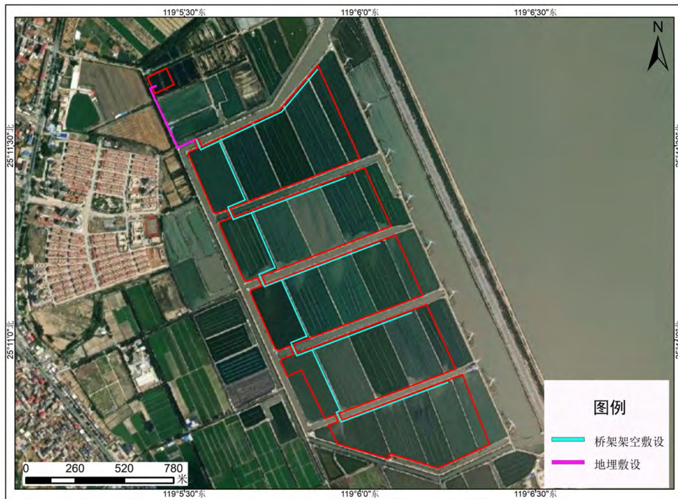
图 3.1-5 35kv 电缆敷设方式示意图
